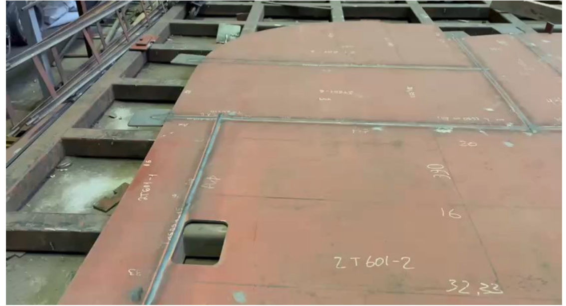
Пример сварных листовых конструкций (полотнище)
